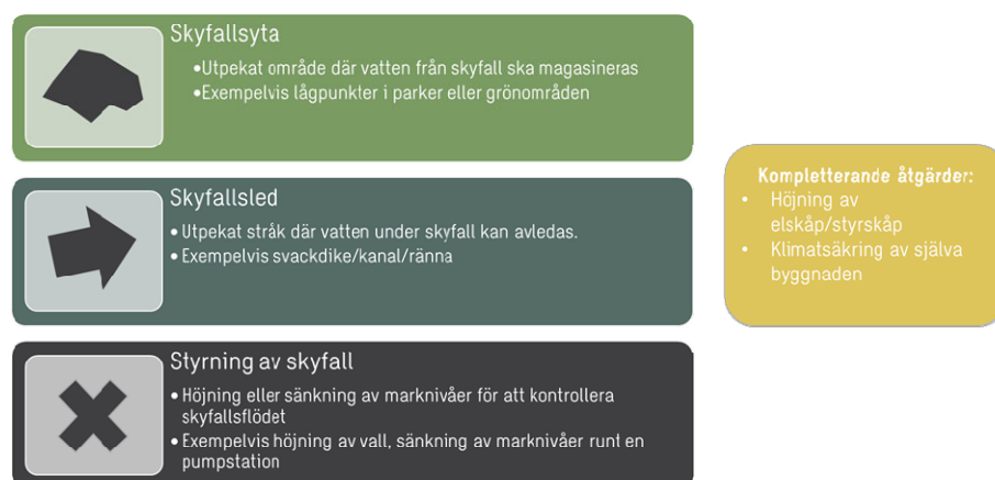
Figur 11. Schematisk illustration av tänkbara skyfallsåtgärder.
