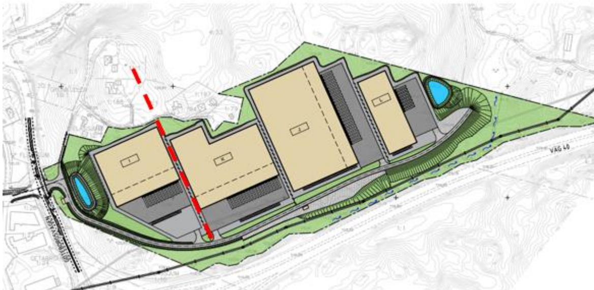
Figur 1. Illustrationsplan över området, M-11-1-204, daterad 2023-05-12. Röd streckad linje visar vattendelaren som delar upp området i två delområden, östra och västra.
