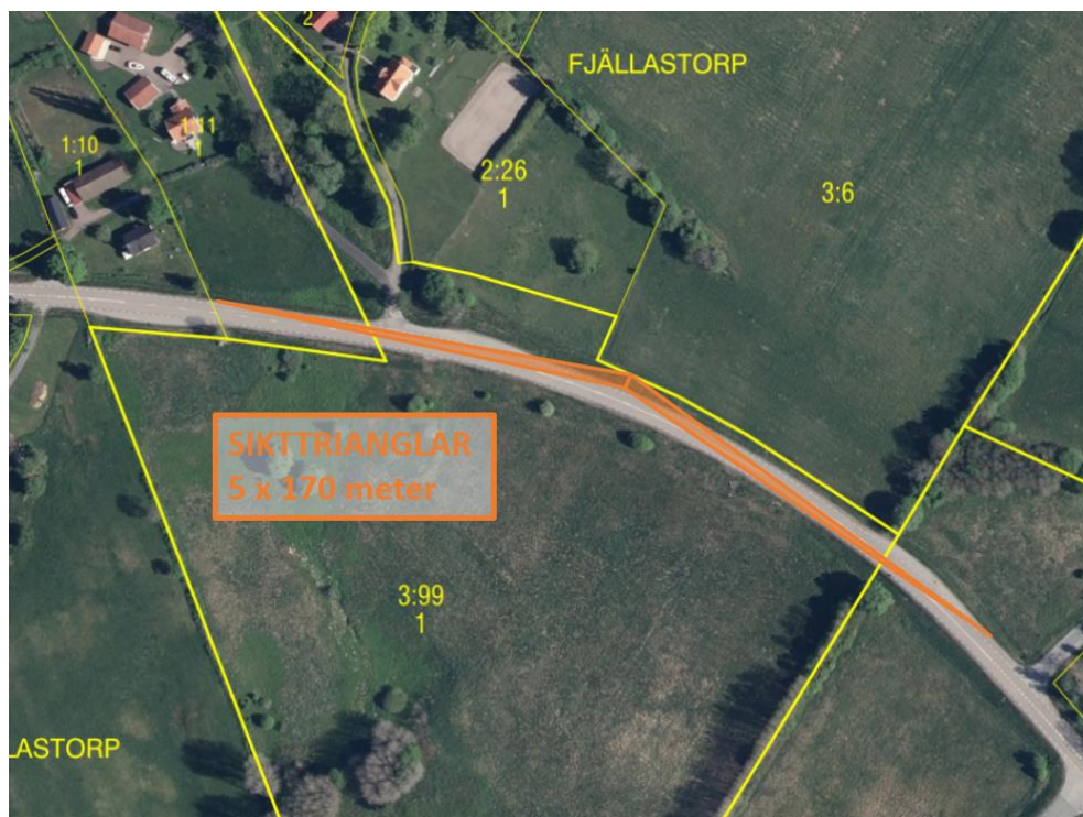
Figur 10. Sikttrianglar för 70 km/h enligt VGU, 5 x 170 meter.
