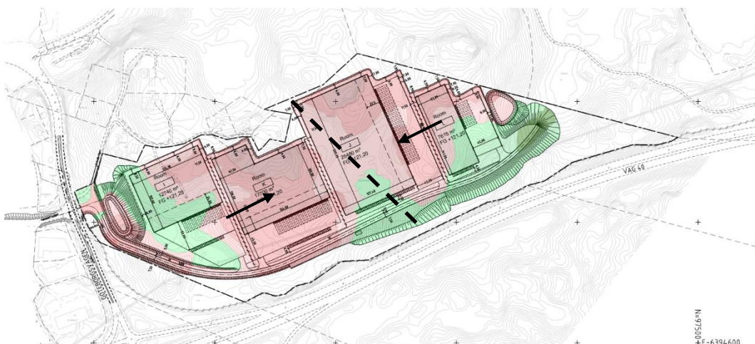
Figur 5. Svarta pilar illustrerar hur salvor ska riktas. Streckad linje innebär ungefärlig gränsdragning.
