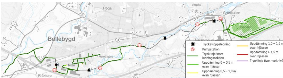
Figur 7. Beräknad maximal uppdämning ovan ledningarnas hjässa samt ovan marknivå när planområdet är utbyggt.
