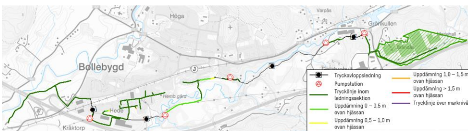
Figur 8. Beräknad maximal uppdämning ovan ledningarnas hjässa samt ovan marknivå när planområdet är utbyggt och överföringsledning från Olsfors är ansluten.
